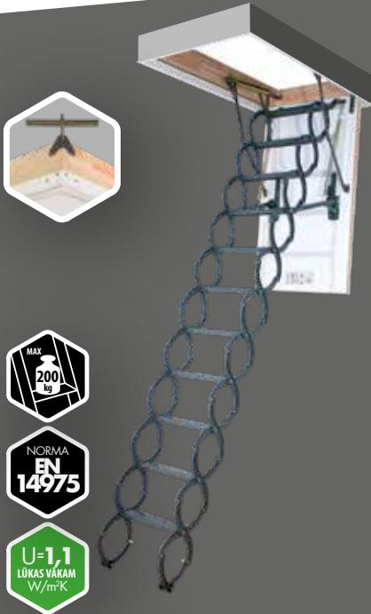
Bēniņu kāpnes **LST** ir sabīdāmas šķērveida kāpnes ar balto, 3,6 cm biezum izolējošu lūkas vāku. Kāpņu lūkas kārba ir izgatavota no koka un tās uzstādīšanai telpas grieost kalpo montāžas kronšteini. Lūkas vāka atvēšanas mehānisms to stabilizē notur jebkurā leņķī un garantē drošu kāpņu izmantošanu. Kāpnes ir nokrāsotas pelēkā krāsā RAL 7022. Pievienojot kāpnēm divus papildus pakāpienus LSS, tās iespējams izmantot telpās ar maksimālo augstumu līdz 330 cm.
