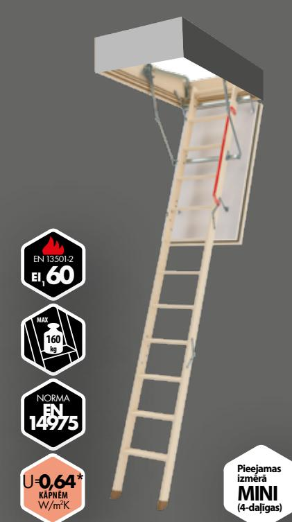
Bēniņu kāpnes **LWF 60** ir jaunās paaudzes ugunsdrošas bēniņu kāpnes, kuras apvieno augstu ugunsdrošību ar ērtu un drošu nokļūšanu bēniņos. Lūkas vāka konstrukcija un izmantotie materiāli nodrošina 60 minūšu aizsardzību pret dūmu un ugums izplatišanos no telpas, kurā ir izcēlies ugunsgrēks  $E_1/E_2 = 60\text{min wg EN 13501-2}$ .
