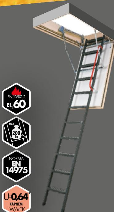
Ugunsdrošās bēniņu kāpnes ar metāla pakāpieniem **LMF 60** ir jaunākās paaudzes produkts, kas atbilst augstām ugunsdrošības prasībām, kā arī nodrošina ērtu un drošu nokļūšanu bēniņos. Kāpnes 60 minūtes nodrošina aizsardzību pret uguns un dūmu nokļūšanu caur bēniņu kāpnēm gan no telpas uz bēniņiem, gan pretējā virzienā (ugunsdrošības klase  $E_1/E_2 = 60\text{min}$ , EN 13501-2). Kāpnes pieejamas arī telpām ar augstiem griestiem – līdz pat 360 cm.
